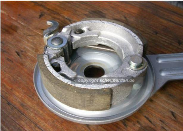
Trommelbremse: Bremsbacken drücken von innen gegen die Trommel.
