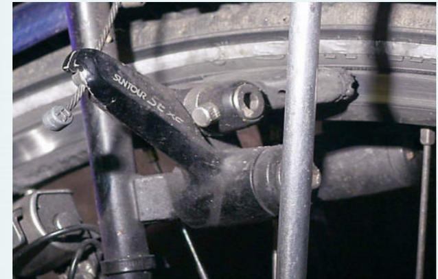
c) Cantilever - Felgenbremse
