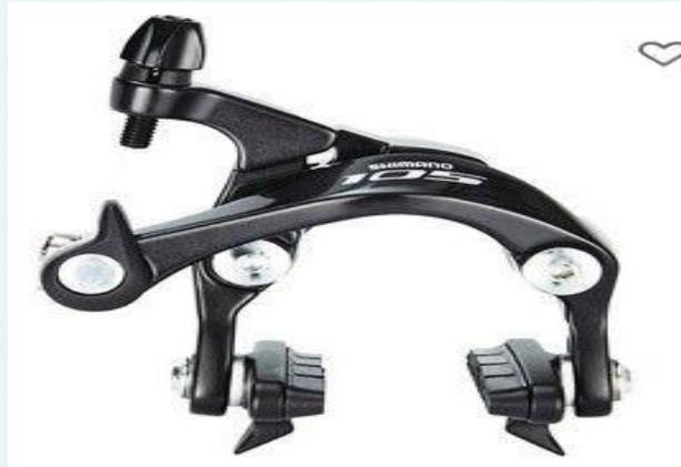
Felgenbremse: Beläge nehmen die Felge seitlich in die Zange.
