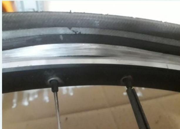
Felgenbruch: Diese wurde dünn gebremst. Metall hält dem Reifendruck nicht mehr stand. **Achtung: Sturzgefahr da ggf. das Rad schlagartig blockiert.**
