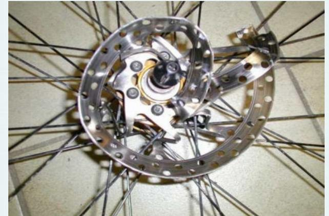
Scheibenbremse: Scheibe verbogen aufgrund mangelnder Wartung der Bremsbeläge (s. unten).
