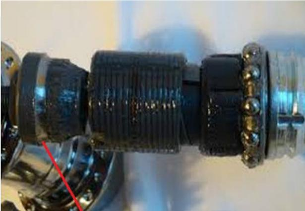
Rücktrittbremse: Konus wird auf Achse nach rechts verschoben. Das Rad bremsst. Wärmeprobleme auf langen Gefällestrrecken.
